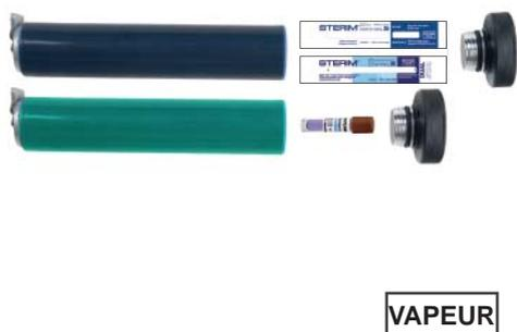
PCD Control est un système du contrôle de charge par simulation qui permet d'évaluer l'efficacité du procédé de stérilisation à la vapeur pour toute la charge. Il est conforme avec la norme PN ISO 11140-1 type 2.
